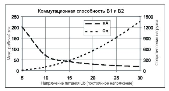
Падение мощности на выходах B1 и B2 максимум 500мВт. Минимально допустимое сопротивление нагрузки может быть определено по диаграмме.
