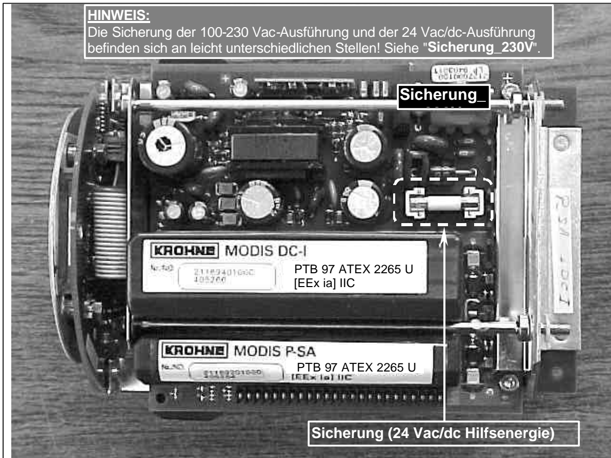
Abbildung 14: Elektronikeinheit IFC 090i-EEx (Abbildung zeigt Ausführung mit 24 Vac/dc).
