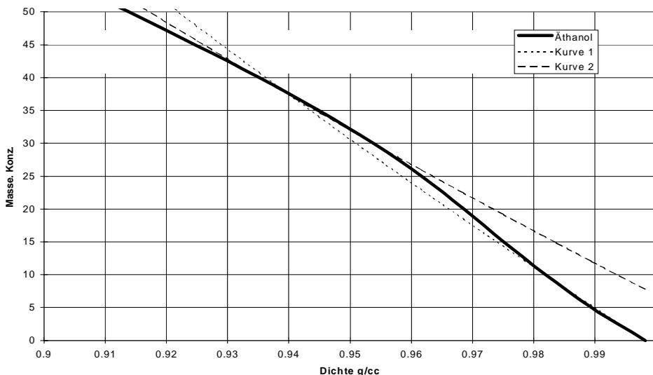
Im obigen Kennfeld deckt sich die Linie von Kurve 1 mit der Kennlinie von etwa 0 bis 12% Ethanol und die Linie von Kurve 2 von 28 bis 43%. Zu beachten ist, daß in diesen Fällen die Flüssigkeit zwar Wasser ist, aber NICHTWASSER einzugeben ist (Fkt. 3.10.4), damit die bestmögliche Deckung der Kurven erzielt wird.
