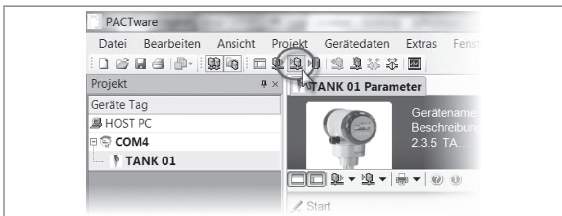
Abbildung 5-3: Taste "Speichern ins Gerät"
