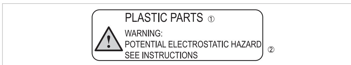
Рисунок 2-1: Самоклеящаяся этикетка с предупреждением об ЭСР (под типовой табличкой прибора)
