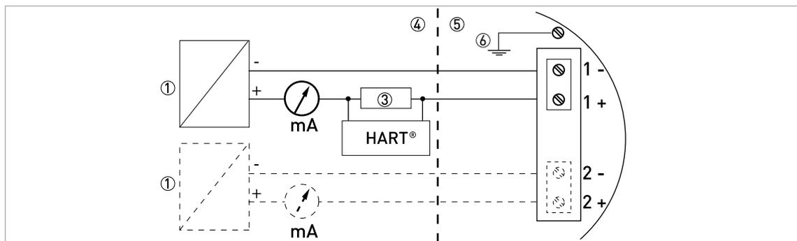
Figura 3-4: Esquema elétrico para equipamento aprovado Ex d ia- e Ex ia tb (com isolamento galvânico)
