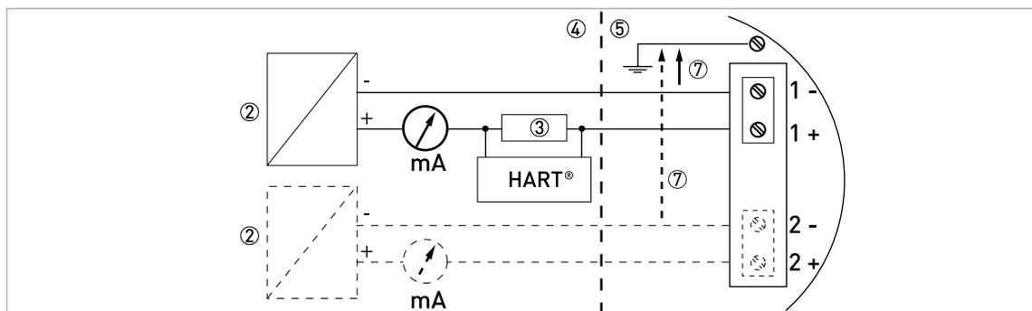
Figura 3-5: Esquema elétrico para equipamento aprovado Ex d ia e Ex ia tb (sem isolamento galvânico)
