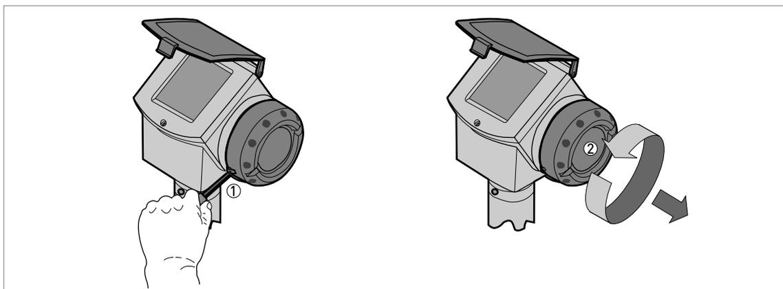
Figura 3-1: Como abrir o compartimento de terminais
