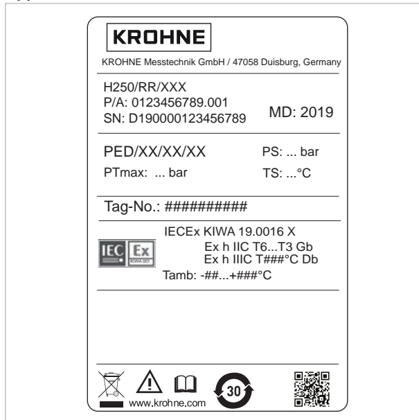
Abbildung 2-6: Beispiel eines Typenschild für H250 M40
