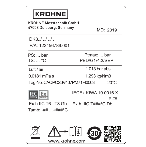
Abbildung 2-5: Beispiel eines Typenschild für DK3x
