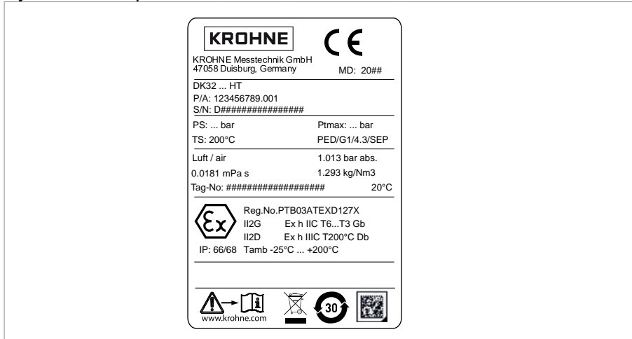
Obrázek 2-8: Příklad výrobního štítku pro DK32 HT (ATEX)
