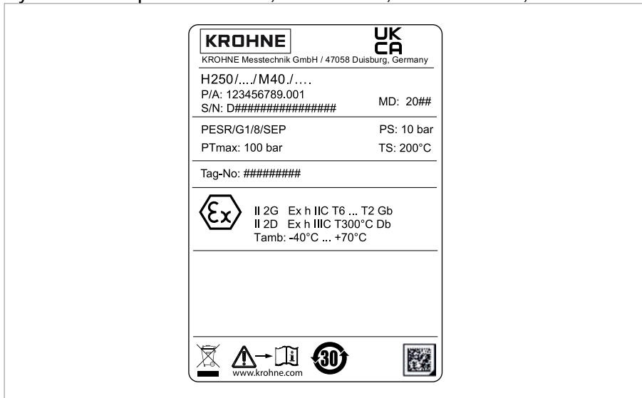
Obrázek 2-11: Příklad výrobního štítku pro H250 M40 (UKCA)
