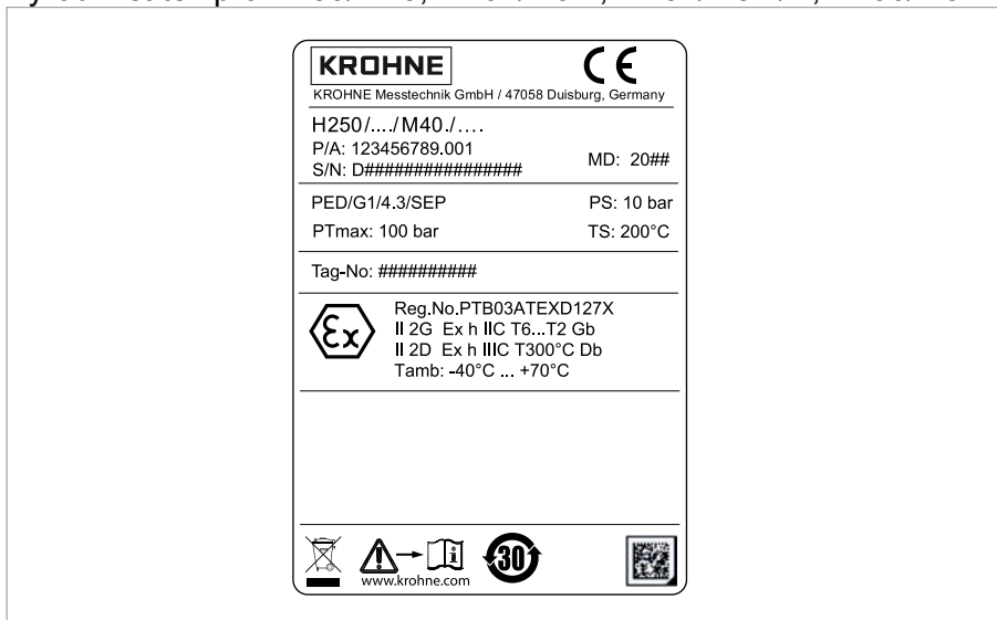
Obrázek 2-10: Příklad výrobního štítku pro H250 M40 (ATEX)
