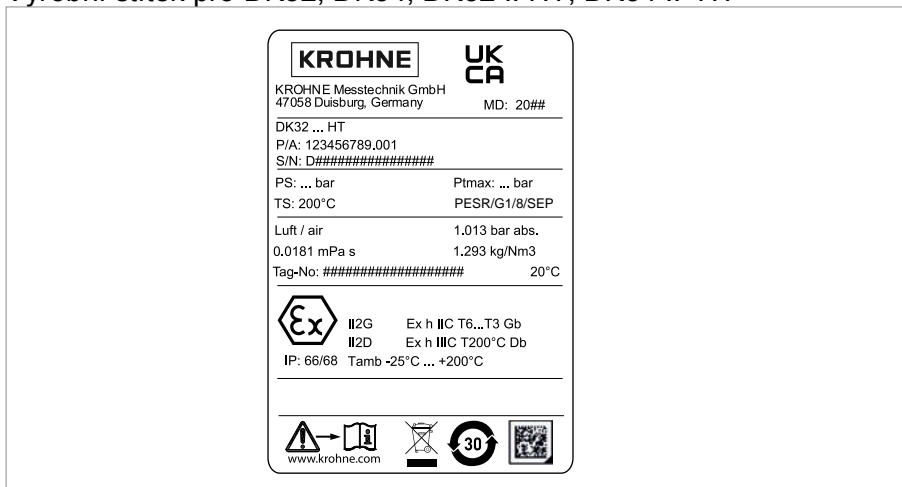
Obrázek 2-9: Příklad výrobního štítku pro DK32 HT (UKCA)
