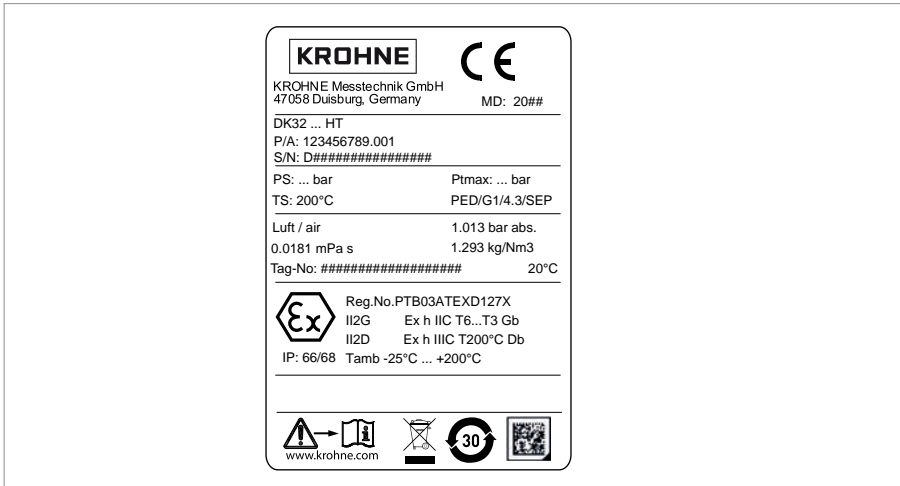
Abbildung 2-8: Beispiel eines Typenschild für DK32 HT (ATEX)
