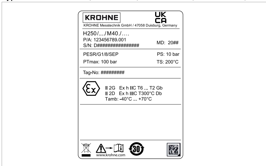
Abbildung 2-11: Beispiel eines Typenschild für H250 M40 (UKCA)
