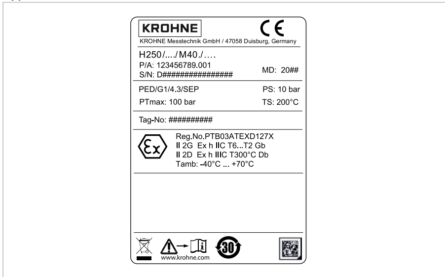
Abbildung 2-10: Beispiel eines Typenschild für H250 M40 (ATEX)
