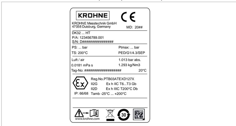
Figura 2-8: Ejemplo de placa de identificación del DK32 HT (ATEX)
