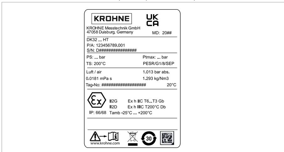
Figura 2-9: Ejemplo de placa de identificación del DK32 HT (UKCA)
