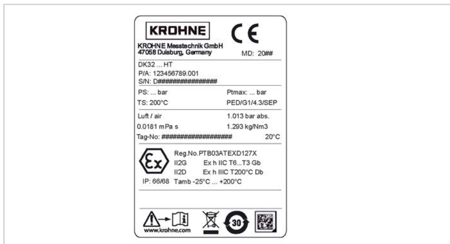
Joonis 2-8. DK32 HT andmesildi näide
