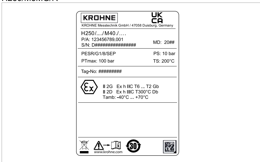
Rys. 2-11: Przykład tabliczki znamionowej wersji H250 M40 (UKCA)
