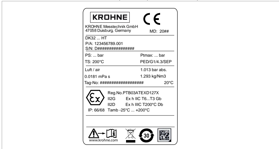
Rys. 2-8: Przykład tabliczki znamionowej wersji DK32 HT (ATEX)
