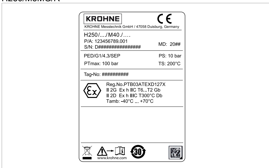
Rys. 2-10: Przykład tabliczki znamionowej wersji H250 M40 (ATEX)
