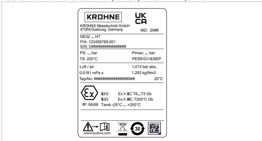
Rys. 2-9: Przykład tabliczki znamionowej wersji DK32 HT (UKCA)
