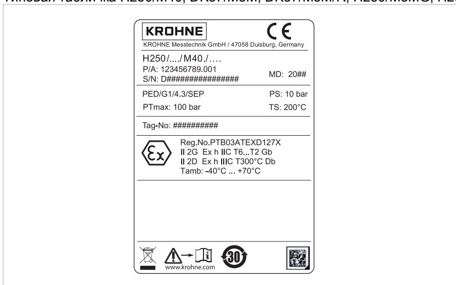
Рисунок 2-10: Пример типовой таблички для H250 M40 (ATEX)
