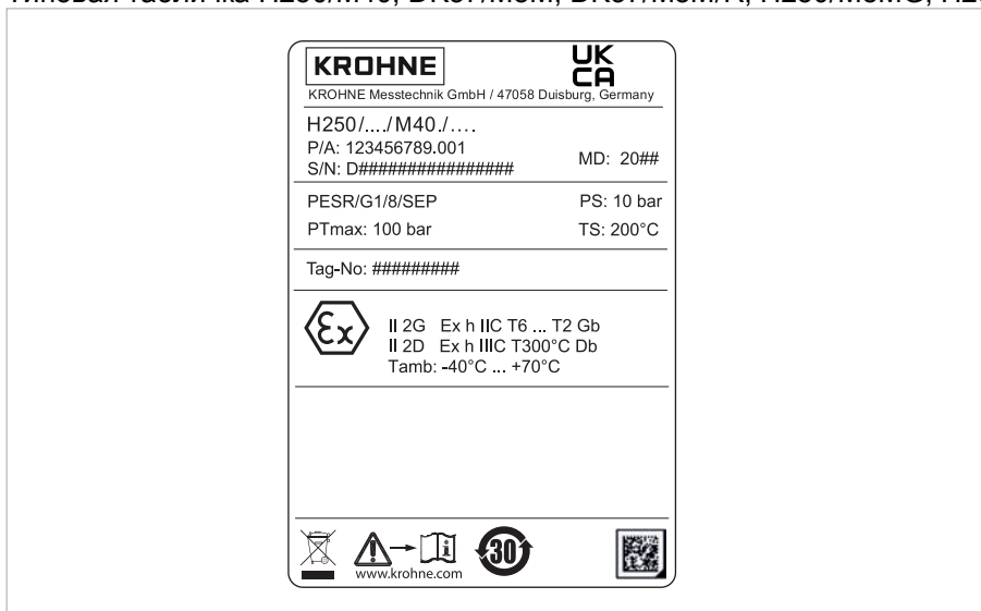
Рисунок 2-11: Пример типовой таблички для H250 M40 (UKCA)
