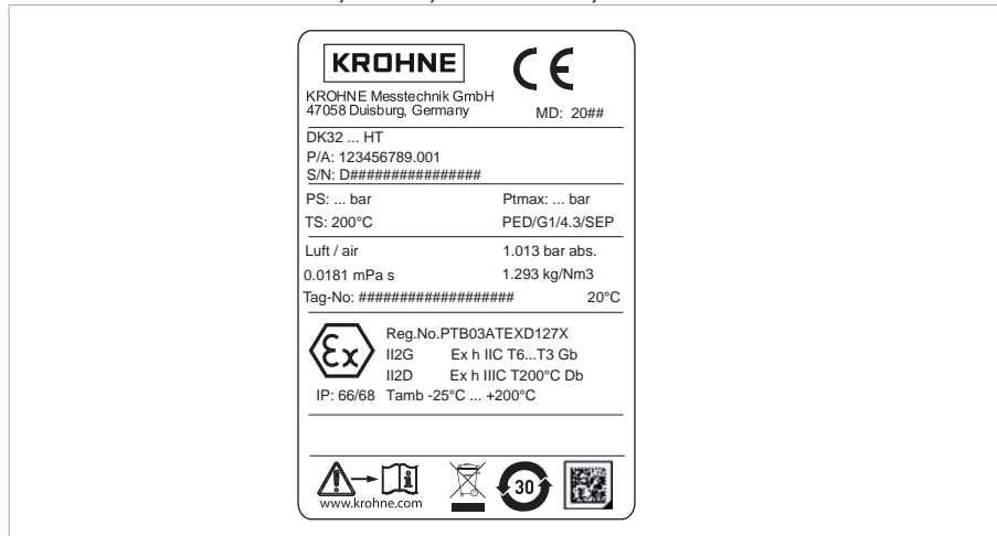
Рисунок 2-8: Пример типовой таблички для DK32 HT (ATEX)
