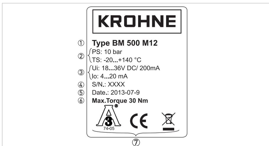
Figure 2-1: Exemple de plaque signalétique
