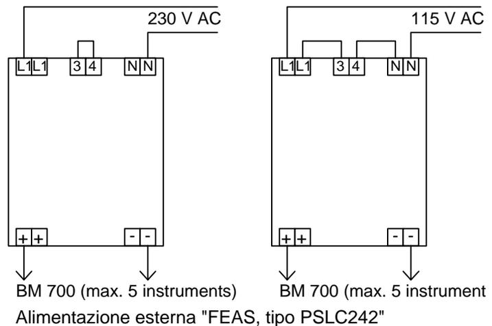
Alimentazione galvanicamente isolata in accordo a VDE 0551
