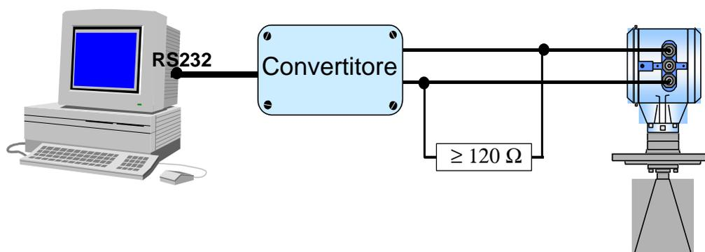
Con il programma PC-CAT, versione 3.00 o superiore, si può configurare il trasmettitore BM 700 in modo molto semplice da PC: collegare l'uscita in corrente del BM 700, con un carico compreso tra  $120 \Omega$  e  $350 \Omega$ , al convertitore Smart/HART (fornito con il programma PC-CAT) e collegare quest'ultimo alla porta seriale del PC.
