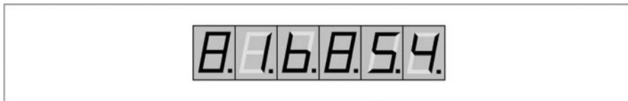
Figura 4-10: Rappresentazione dell'overflow del contatore
