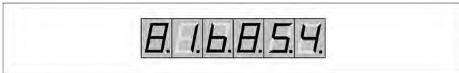
Рисунок 4-10: Обозначение переполнения счетчика
