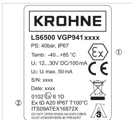
Obrázek 2-2: Příklad štítku do prostředí s nebezpečím výbuchu
