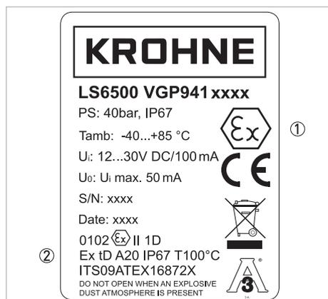
Abbildung 2-2: Beispiel eines Ex-Typenschilds
