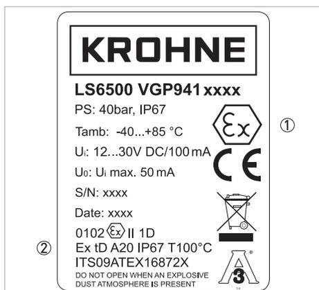
Figure 2-2: Exemple de plaque signalétique Ex
