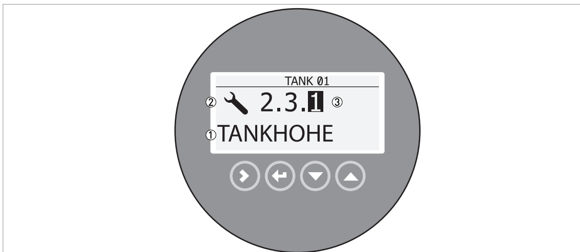
Abbildung 5-2: Aufbau des lokalen Anzeigebildschirms im Konfigurationsmodus
