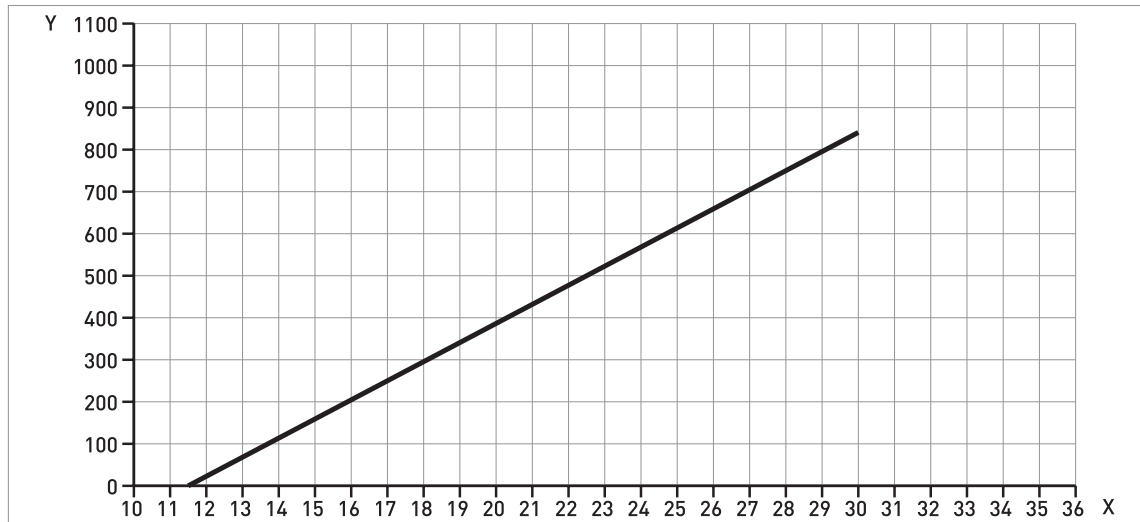
Abbildung 8-2: Mindestspannungsversorgung für einen Ausgangswert von 22 mA an der Anschlussklemme (Nicht-Ex und Zulassung für explosionsgefährdete Standorte (Ex i / IS))
