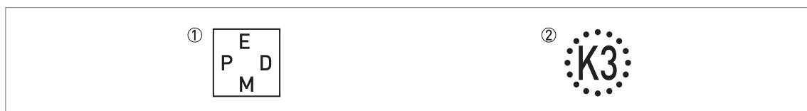
Figura 2-3: Símbolos referentes al material de la junta suministrada (en el lado de la conexión a proceso)
