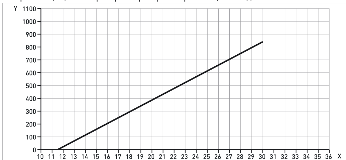
Рисунок 8-2: Минимальное напряжение питания при выходном токе 22 мА на клеммах (для приборов невзрывозащищённого исполнения и исполнения с взрывозащитой вида Ex i / IS)
