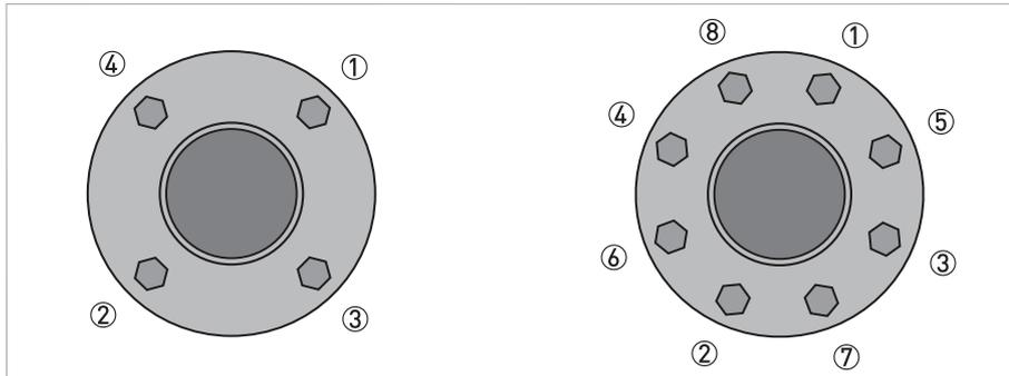
Mettre en œuvre une routine régulière pour serrer les boulons de façon homogène.
