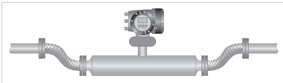
Il est possible d'utiliser des raccordements flexibles, mais en raison des débits élevés associés aux débitmètres de grand diamètre, il est recommandé de les réserver aux débitmètres inférieurs à 80.
