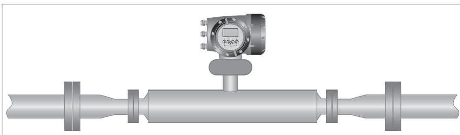
Evitare sempre variazioni discontinue estreme nella misura dei tubi. Utilizzare raccordi di riduzione per tubazione qualora ci sia una grande differenza tra la misura della tubazione e le flange del misuratore.
