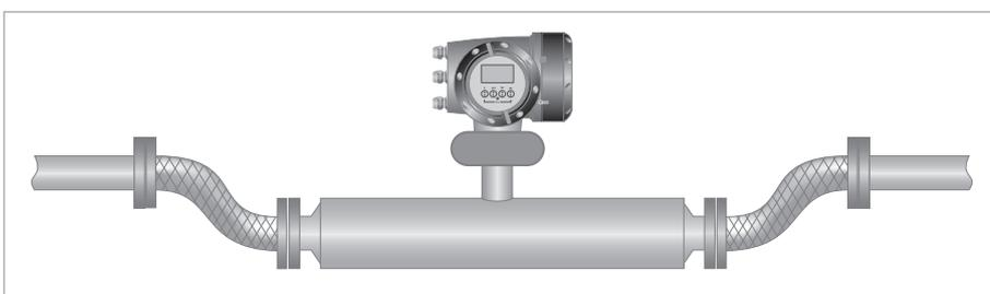
Gli attacchi flessibili possono essere usati ma, a causa delle elevate velocità di flusso associate con misuratori di diametro ampio, si raccomanda che gli attacchi flessibili non siano utilizzati su misuratori più grandi della misura 80.
