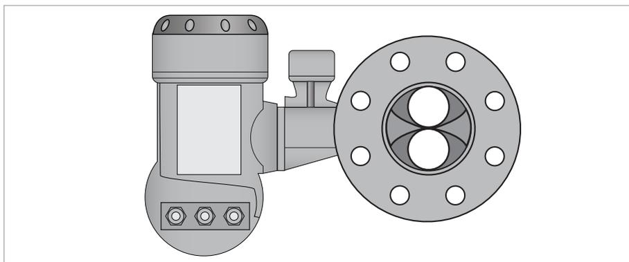
Il misuratore può essere installato con il convertitore di segnale (o scatola di giunzione remota) sul lato del misuratore in modo tale che i tubi di misura si trovino uno sopra all'altro. Evitare questo metodo di installazione se il flusso di processo ha due fasi e se il fluido di processo contiene gas. Se non è possibile evitare questa situazione, contattare il produttore per ricevere consigli.
