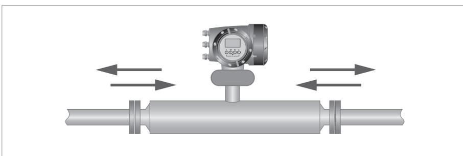
I misuratori di portata massici hanno un livello massimo di forza (negativa o positiva) che può essere applicata alle estremità del misuratore. Fare riferimento alla tabella nella sezione dei dati tecnici di questo manuale per i carichi massimi sulle estremità.
