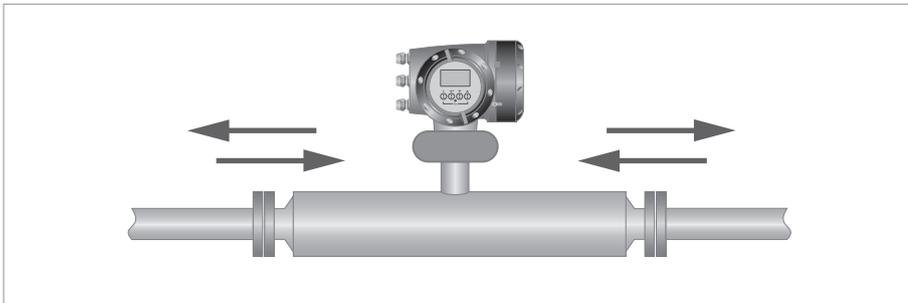
Los caudalímetros másicos tienen un nivel de presión máxima (negativa o positiva) que se puede aplicar a los extremos del caudalímetro. Consulte las presiones permitidas en la tabla que figura a continuación.
