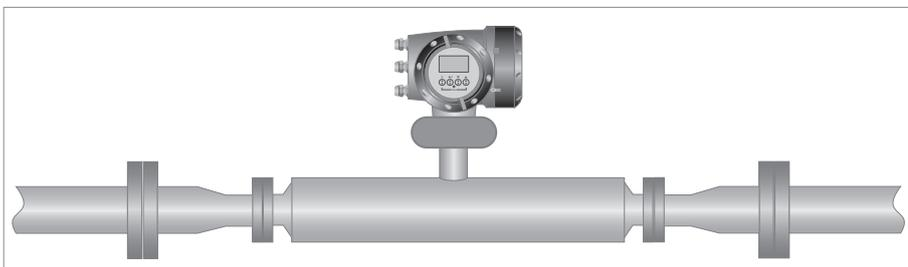
Evite siempre los cambios drásticos de tamaño en la tubería. Utilice racores cuando haya una diferencia considerable entre el tamaño de la tubería y las bridas del medidor.
