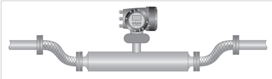
Se pueden utilizar conexiones flexibles pero, debido al alto caudal que presentan los medidores de gran diámetro, se recomienda no utilizar conexiones flexibles en medidores de tamaño superior a 80.
