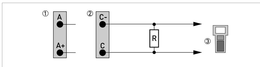
Figura 4-28: Connessione HART® attiva (I<sub>a</sub>)
