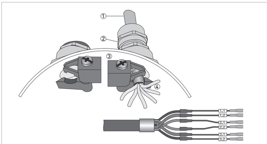
Figura 4-2: Bloccare i cavi sulla boccola di schermatura
