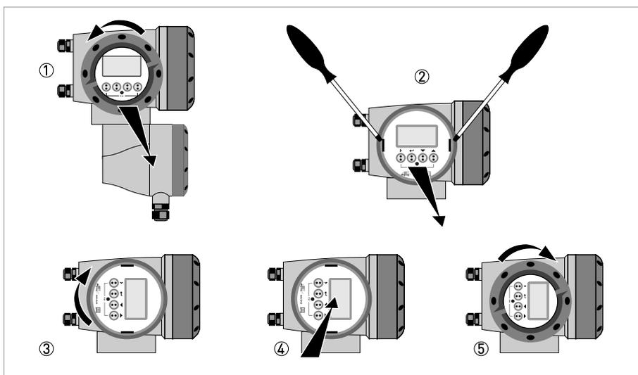
Figura 3-16: Ruotare il display della versione con custodia da campo
