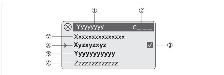
Figura 6-5: Display durante l'anteprima dei parametri, 4 linee
