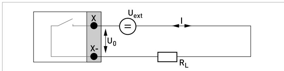
Figura 4-10: Uscita di stato / contatto, passivo  $S_p$ **Contatto d'ingresso passivo, I/O di base**
