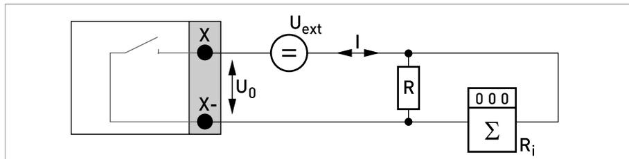
Figura 4-15: Uscita in frequenza ad impulsi passiva  $P_p$
