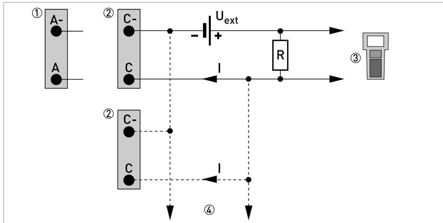
Figura 4-29: Connessione HART<sup>®</sup> passiva ( $I_p$ )
