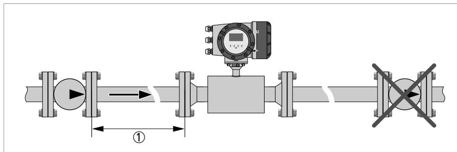
Figura 3-9: Posizione della pompa
