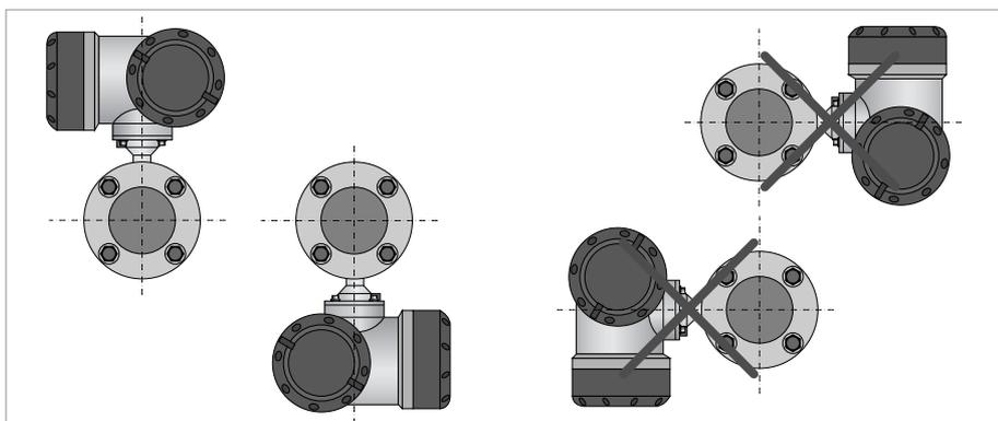
Figura 3-14: Montaggio orizzontale e verticale
