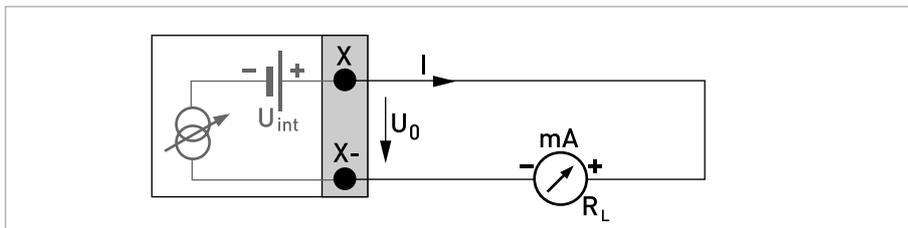
Figura 4-23: Uscita in corrente attiva  $I_a$  Ex i
