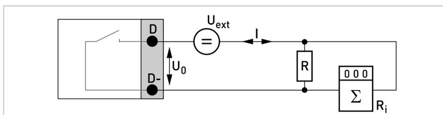
Figura 4-9: Uscita ad impulsi/frequenza, passiva P<sub>p</sub>
