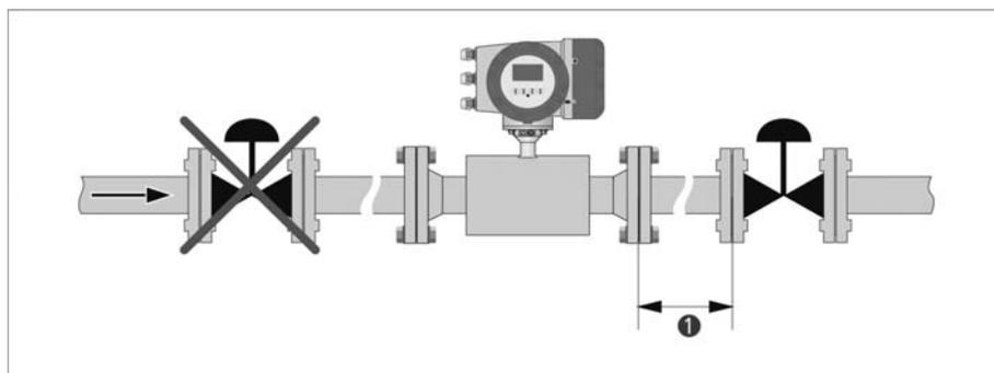
Figura 3-10: Installazione davanti ad una valvola di regolazione
