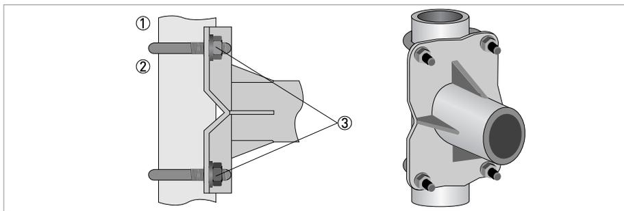
Figura 3-15: Montaggio su tubazione della custodia da campo
