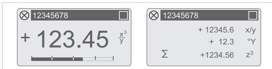
Figura 5-1: Display nella modalità di misura (esempi per 2 o 3 valori misurati)
