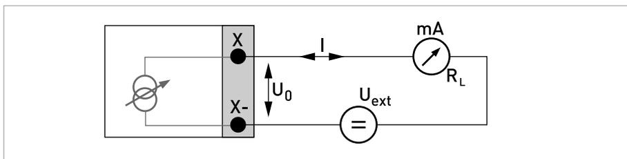
Figura 4-24: Uscita in corrente passiva I<sub>p</sub> Ex i
