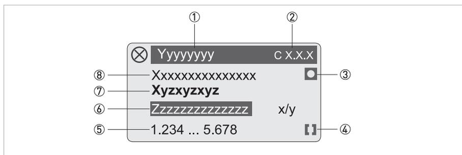
Figura 6-4: Display durante l'impostazione dei parametri, 4 linee
