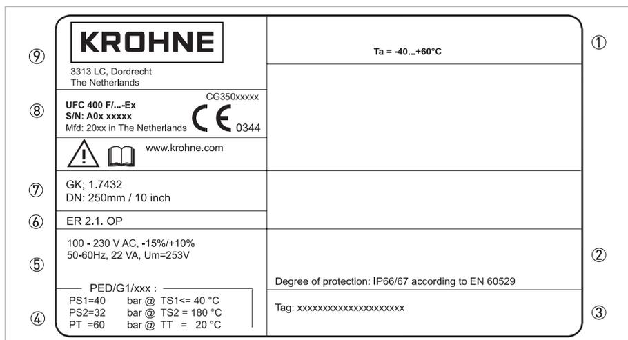
Figura 2-4: Esempi di targhette sul convertitore di segnale (versione da campo)
