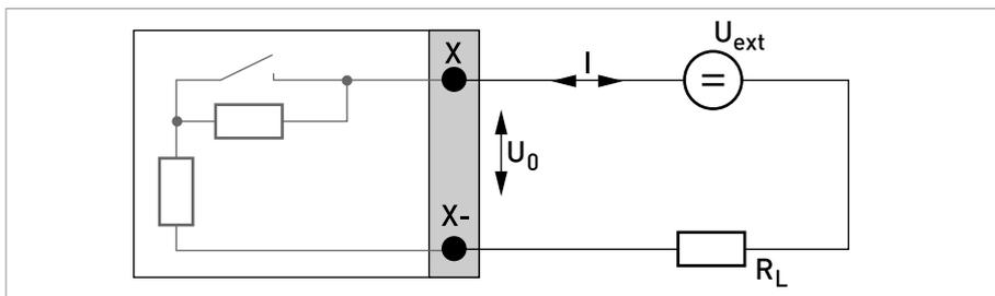
Figura 4-25: Uscita ad impulsi e in frequenza passiva P<sub>N</sub> secondo NAMUR EN 60947-5-6 Ex i
