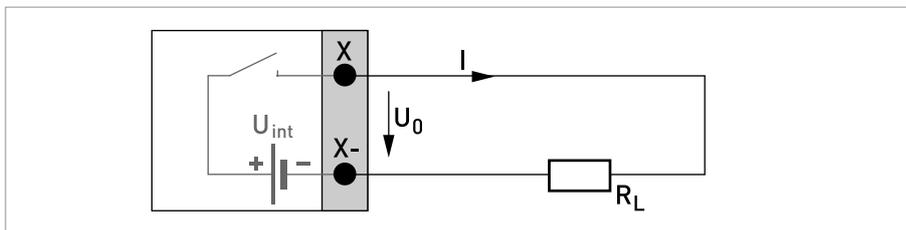
Figura 4-17: Uscita di stato / contatto attivo  $S_a$ **Uscita di stato / contatto passivo, I/O modulari**
