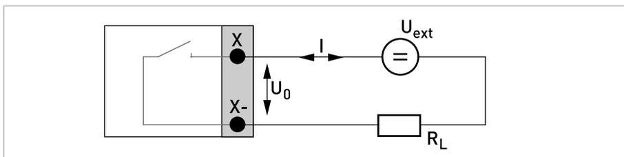
Figura 4-18: Uscita di stato / contatto passivo  $S_p$ **Uscita di stato/contatto di soglia  $S_N$  NAMUR, I/O modulari**
