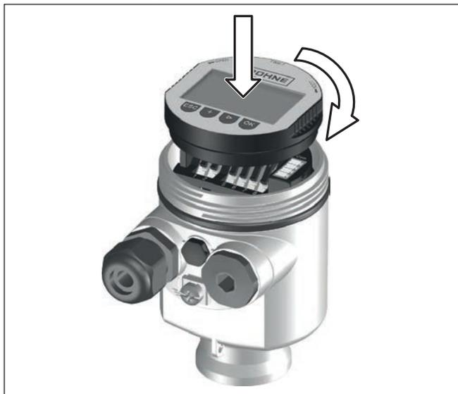
Fig. 23: Poner el módulo de visualización y configuración en la carcasa de una cámara
