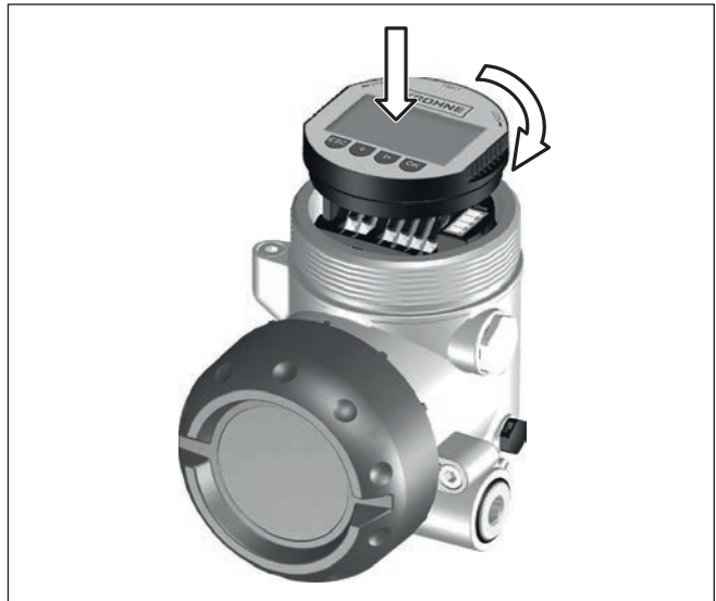
Abb. 20: Anzeige- und Bedienmodul einsetzen
