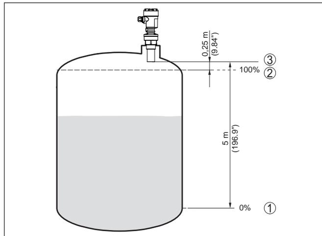
Fig. 22: Exemplo de parametrização Calibração Mín./Máx.
