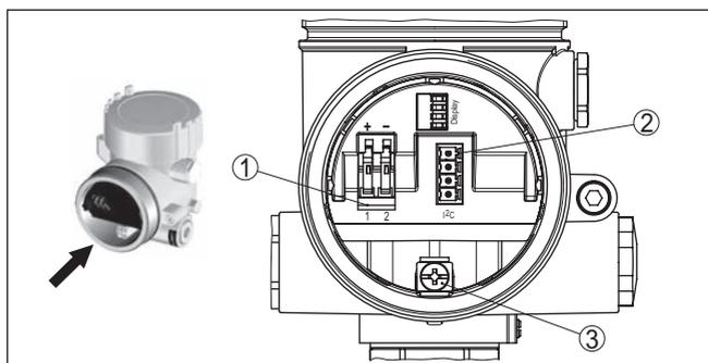
Fig. 18: Compartimento de conexão da caixa de duas câmaras
