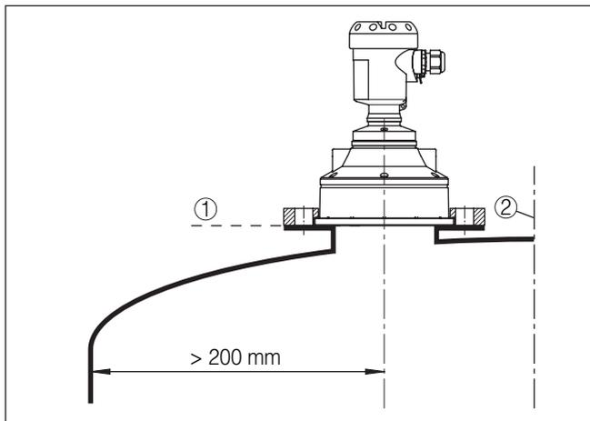
Fig. 5: Montagem em tampa redonda do reservatório
