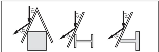
Fig. 11: Cobrir os perfis lisos com defletores
