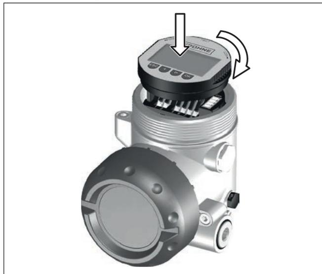
Fig. 20: Colocar o módulo de visualização e configuração
