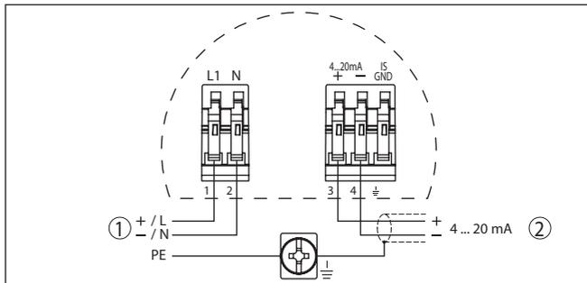
Fig. 19: Esquema de ligações - Caixa de duas câmaras
