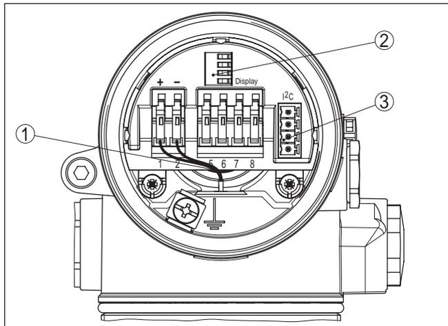
Fig. 17: Compartimento do sistema eletrônico da caixa de duas câmaras
