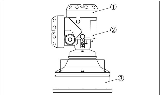
Fig. 1: OPTISOUND 3030 C, Caixa de alumínio de duas câmaras
