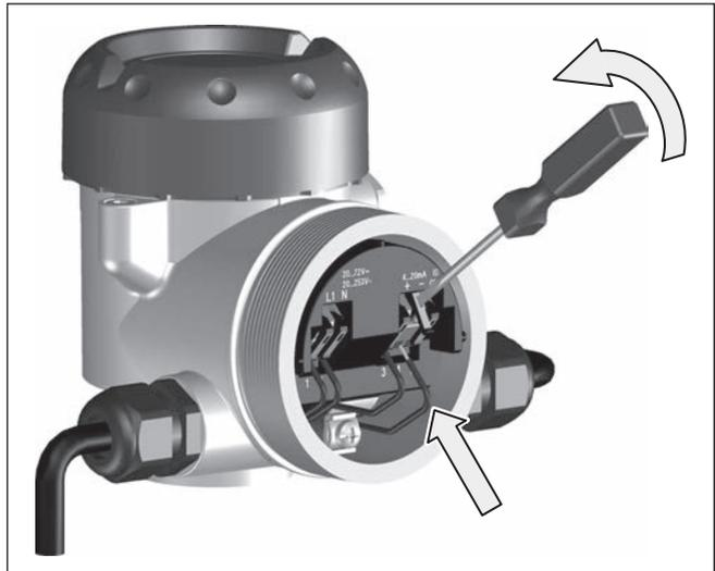
Fig. 15: Passos 5 e 6 do procedimento de conexão
