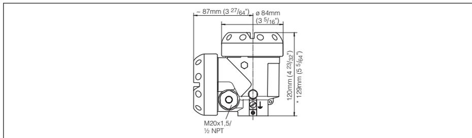
Fig. 25: Caixa de duas câmaras de aço inoxidável com grau de proteção IP66/IP68, 0,2 bar (com o módulo de visualização e configuração montado, a altura da caixa é aumentada em 18 mm/0.71 in
