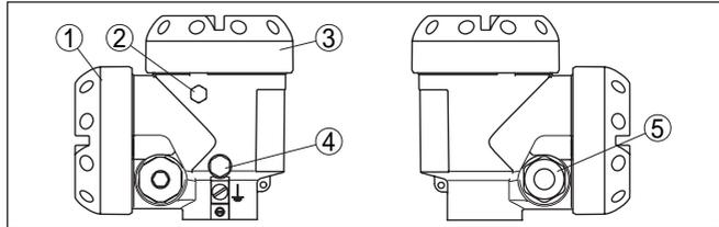
Abb. 19: Zweikammergehäuse
