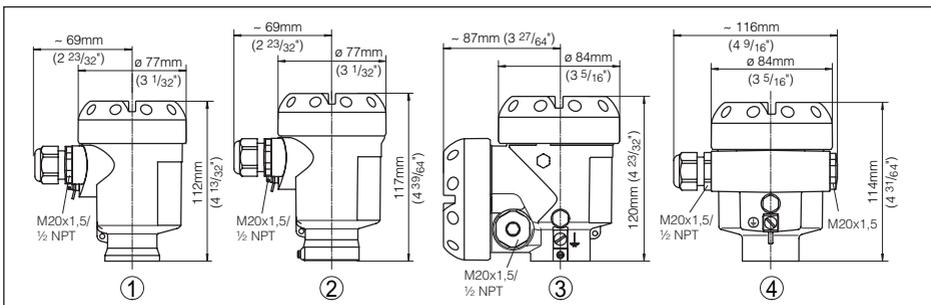
Abb. 29: Gehäuseausführungen in Schutzart IP66/IP67 und IP66/IP68; 0,2 bar (mit eingebautem Anzeige- und Bedienmodul vergrößert sich die Gehäusehöhe bzw. -breite um 9 mm/0.35 in)
