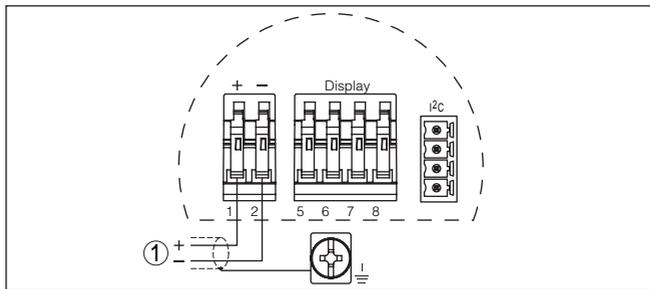
Abb. 18: Anschlussplan - Einkammergehäuse
