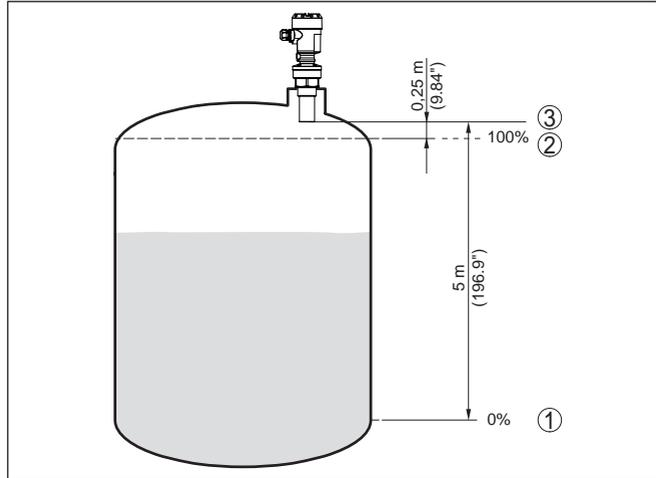
Abb. 25: Parametrierbeispiel Min./Max.-Abgleich
