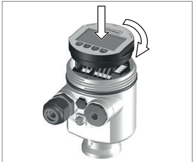
Fig. 23: Display- en bedieningsmodule in de eenkamerbehuizing plaatsen
