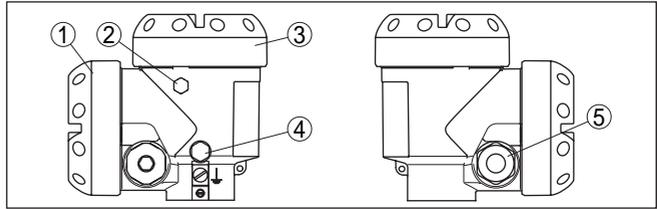
Abb. 18: Zweikammergehäuse
