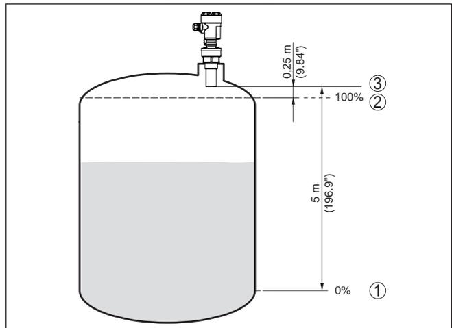
Abb. 24: Parametrierbeispiel Min.-/Max.-Abgleich
