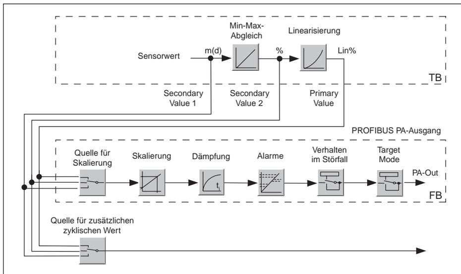
Abb. 26: OPTISOUND 3030 C: Blockschaltbild mit AI (PA-OUT)-Wert und zusätzlichem zyklischen Wert
