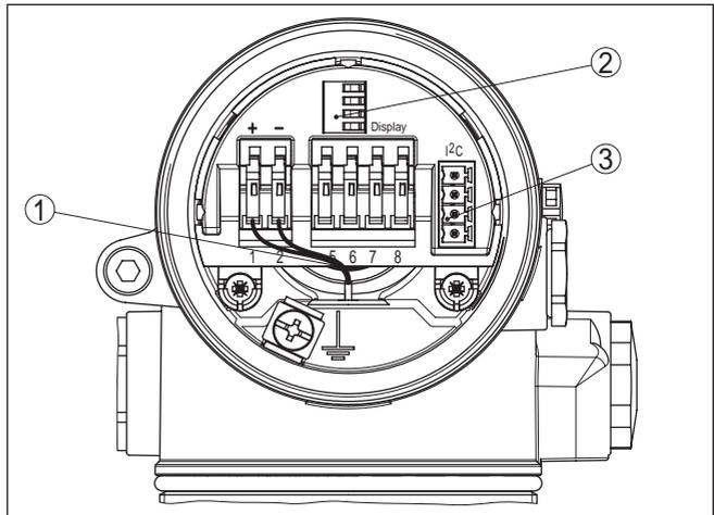
Abb. 19: Elektronikraum Zweikammergehäuse
