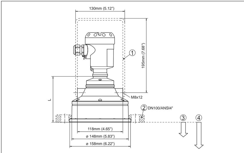
Abb. 30: OPTISOUND 3030 C, Maß L bei Aluminiumgehäuse = 118 mm (4.646"), bei Kunststoffgehäuse = 112 mm (4.409"), bei Edelstahlgehäuse = 107 mm (4.213")
