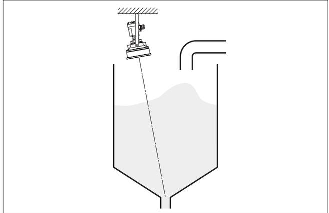
Abb. 9: Ausrichtung in Schüttgütern
