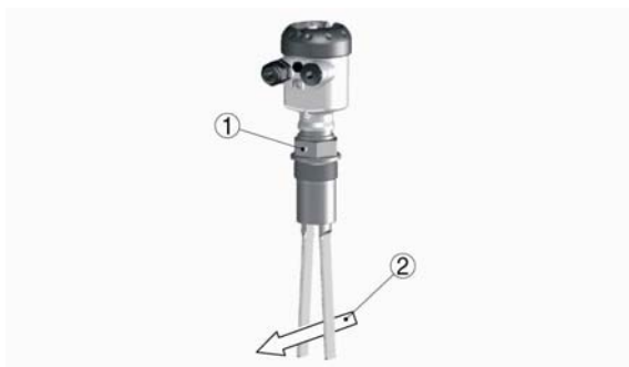
Obr.5: Orientace snímače v případě pohybu materiálu v nádrži
