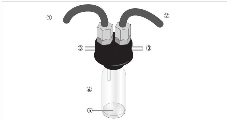
Abbildung 2-3: Beschreibung der Ultraschall-Messküvette mit Durchflussarmatur
