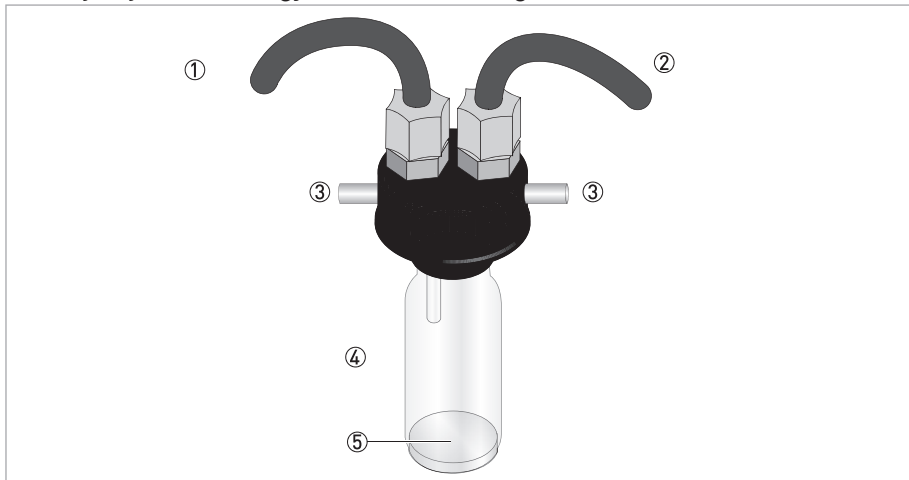
Figur 2-3: Beskrivelse av ultralydkyvette med gjennomstrømningsholder
