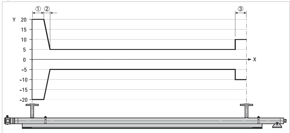
Figure 8-4: Précision de mesure / distance par rapport aux raccords process de la chambre de mesure, en mm
