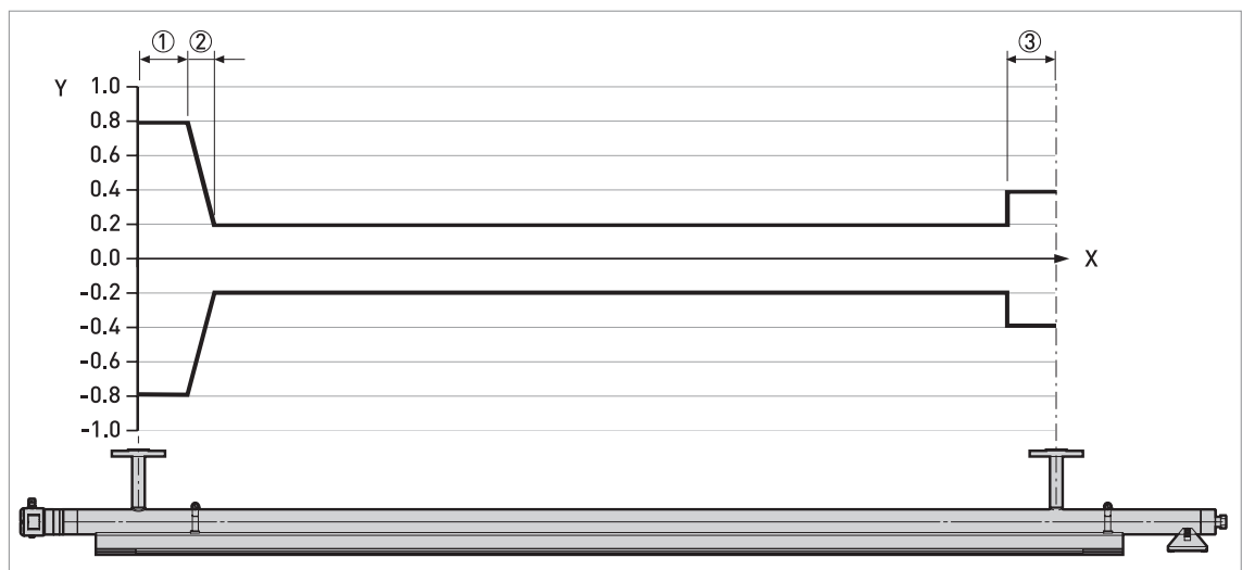
Рисунок 8-5: Погрешность измерения / дистанция от технологических присоединений выносной камеры, в дюймах
