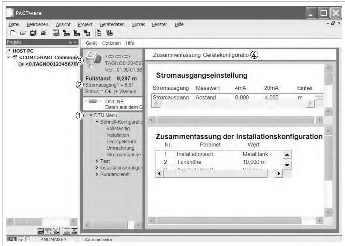
Abbildung 5-2: Anzeigebildschirm der PACTware™-Bedienoberfläche
