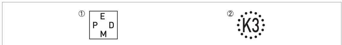
Figure 2-4: Symboles relatifs au matériau du joint fourni (sur le côté du raccordement process)
