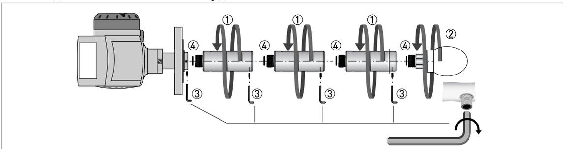
Рисунок 3-13: Каплевидная антенна - как присоединить антенные удлинители
