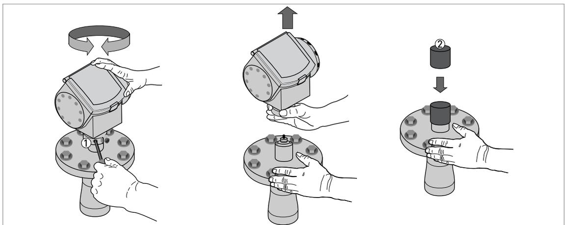
Рисунок 3-14: Поворот или снятие преобразователя сигналов
