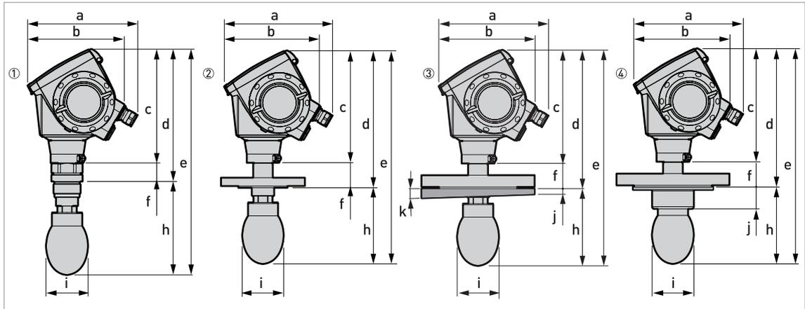
Рисунок 8-13: Исполнения каплевидной антенны DN80/3"
