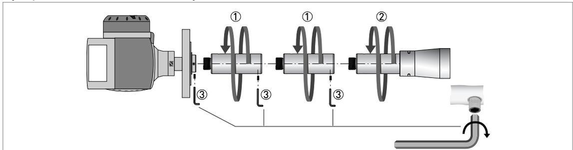
Рисунок 3-12: Рупорная антенна - как присоединить антенные удлинители
