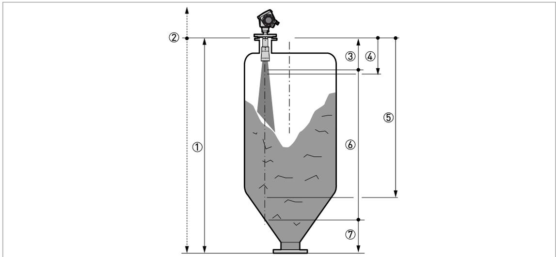
Рисунок 6-4: Измерение дистанции
