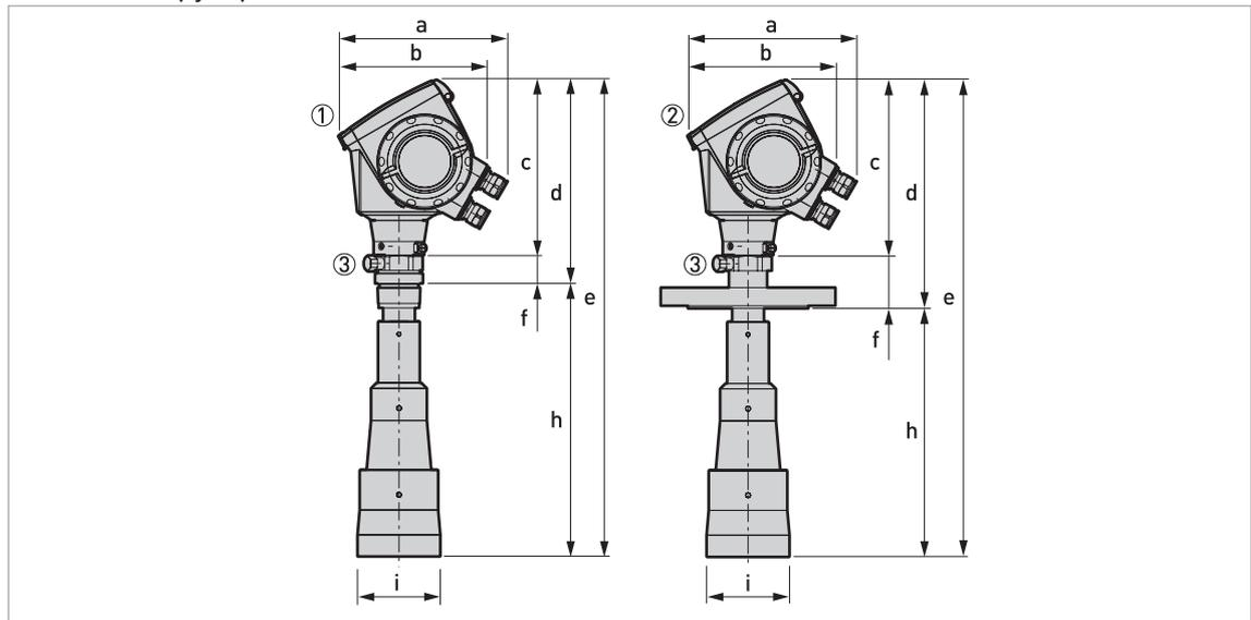
Рисунок 8-11: Исполнения рупорной антенны DN100/4"
