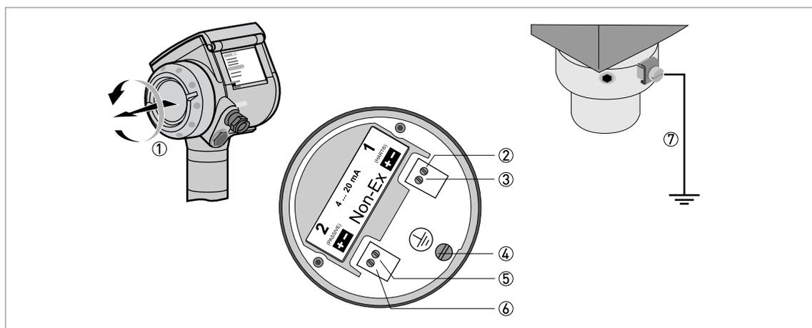
Рисунок 4-1: Электрическое подключение
