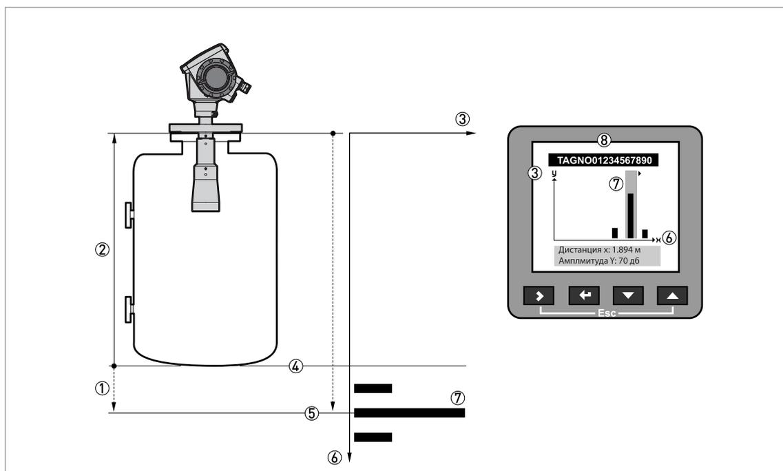
Рисунок 6-8: Окно сигналов и отражение от дна силоса
