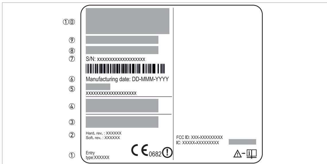
Рисунок 2-5: Типовая табличка прибора невзрывозащищенного исполнения
