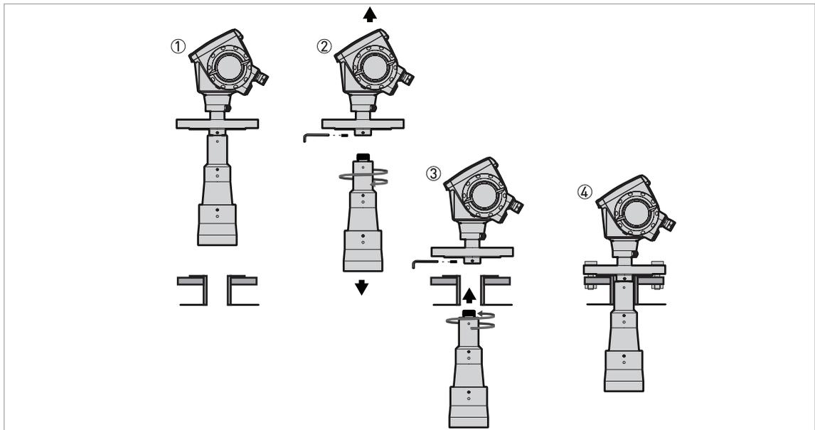
Рисунок 3-9: Как закрепить прибор, если антенна больше, чем технологическое присоединение
