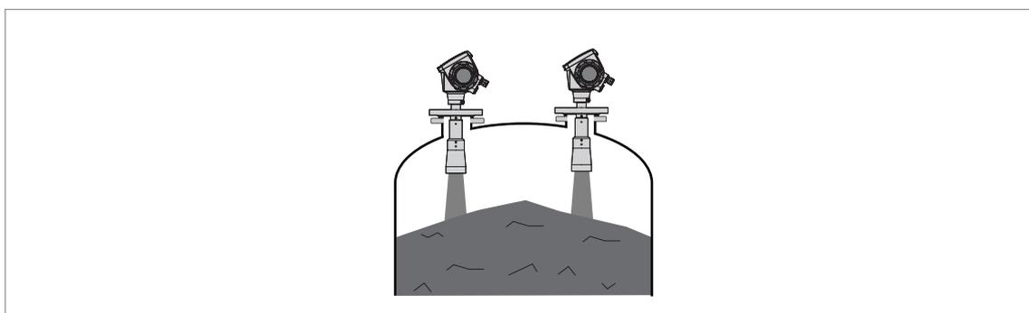
Рисунок 3-6: На одном силосе может использоваться более одного FMCW радарного уровнемера
