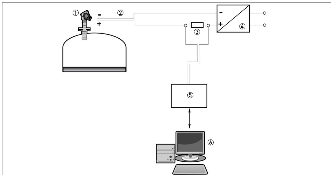
Рисунок 4-4: Двухточечное подключение (для приборов невзрывозащищённого исполнения)
