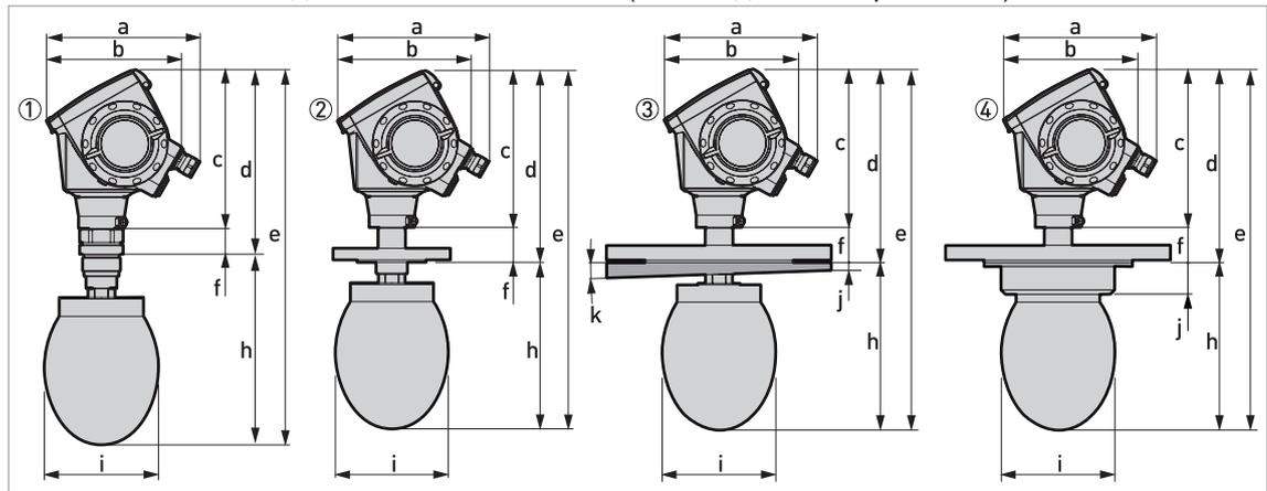
Рисунок 8-14: Исполнения каплевидной антенны DN150/6" (только для полипропилена)
