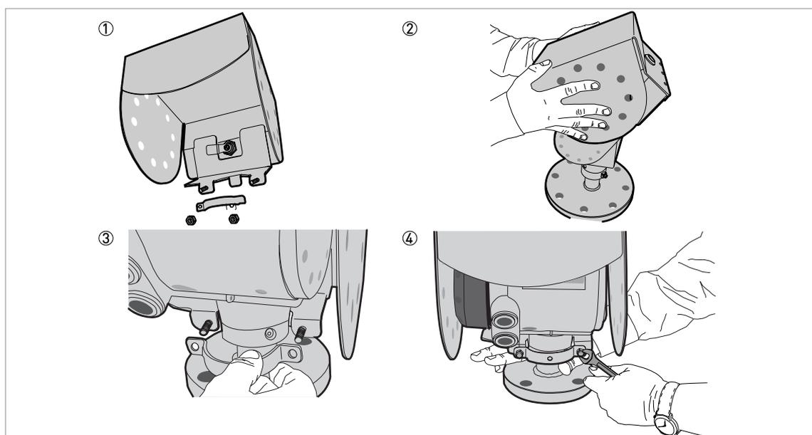
Рисунок 3-15: Установка защитного козырька
