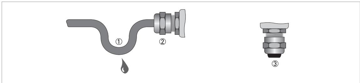
Рисунок 4-3: Монтаж в соответствии со степенью пылевлагозащиты IP67
