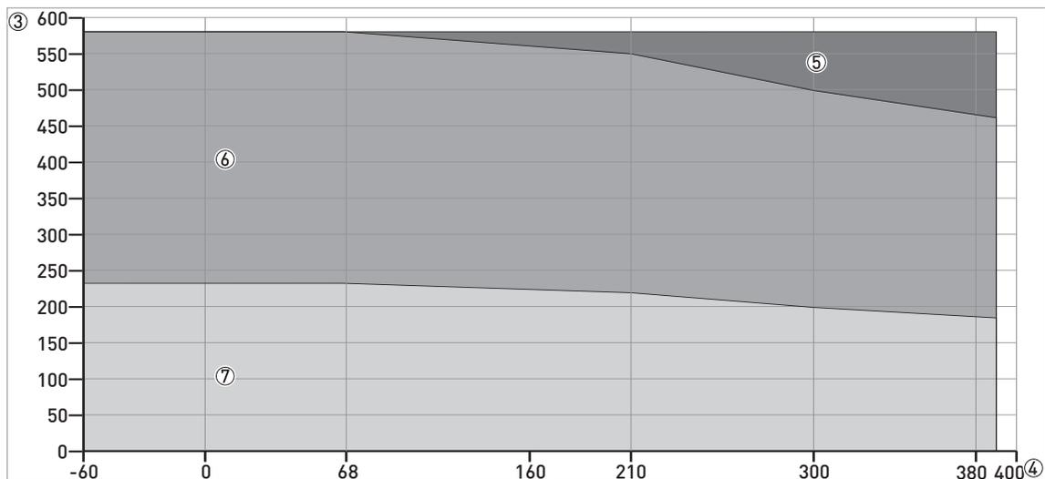
Рисунок 8-5: Номинальное давление / температура (EN 1092-1), фланцевое и резьбовое технологическое присоединение, в °F и фунт/кв.дюйм изб
