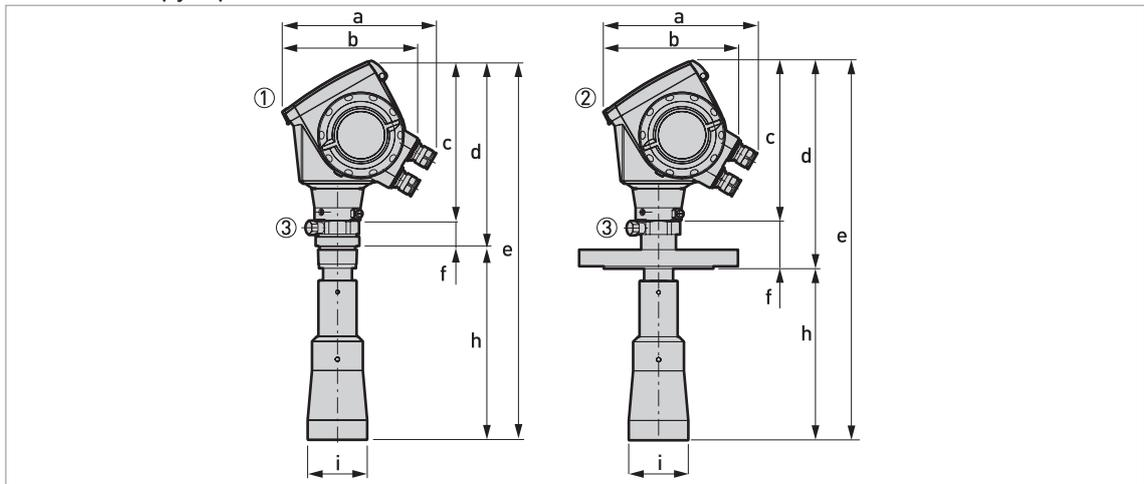
Рисунок 8-10: Исполнения рупорной антенны DN80/3"
