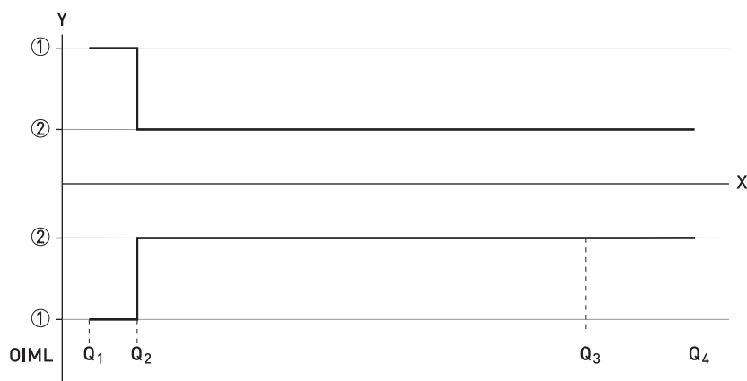
Рисунок 8-2: Расходы согласно стандарт Международной организации по стандартизации (ISO) добавлены к рисунку для сравнения с Директивой по измерительному оборудованию (MID)
