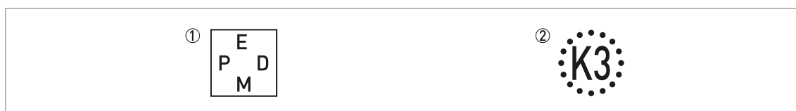
Figura 2-3: Símbolos referentes al material de la junta suministrada (en el lado de la conexión a proceso)
