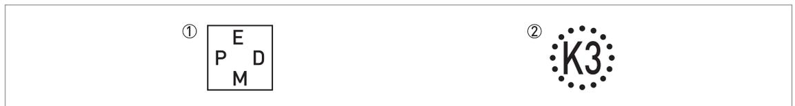
Figure 2-3: Symboles relatifs au matériau du joint fourni (sur le côté du raccordement process)
