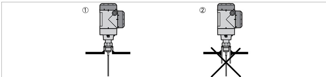
Figure 2-14: Douilles pour les raccords process filetés
