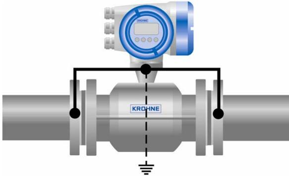
Tuberías metálicas, con recubrimiento interno, y tuberías de plástico. Puesta a tierra con anillos.
