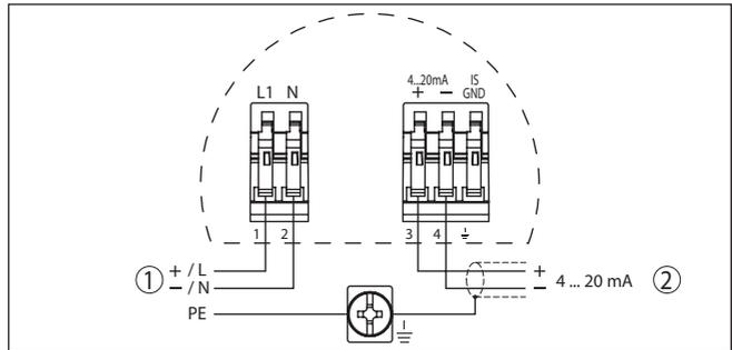
Abb. 4: Anschlussplan - Zweikammergehäuse
