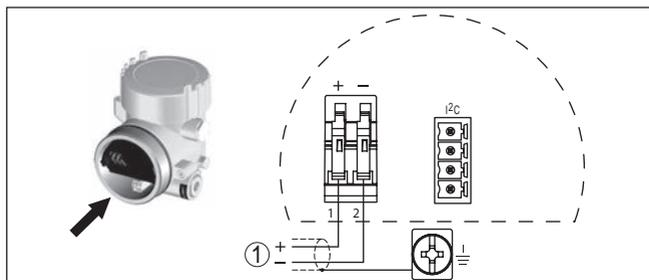
Figura 5: Schema di allacciamento - custodia a due camere
