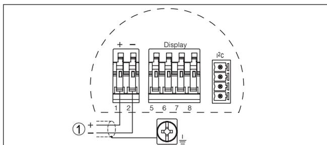
Figura 4: Schema di allacciamento - custodia a una camera
