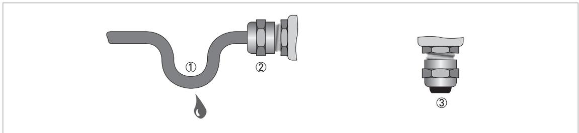
Рисунок 3-3: Монтаж в соответствии со степенью пылевлагозащиты IP67
