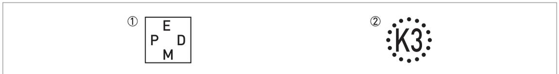
Рисунок 2-4: Символы материала уплотнительной прокладки (на боковой стороне технологического присоединения)
