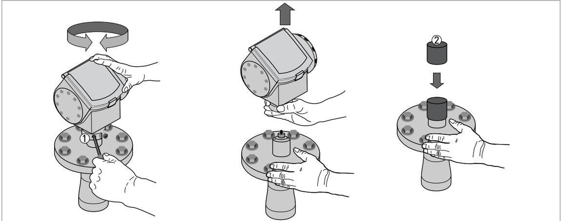
Рисунок 2-16: Поворот или снятие преобразователя сигналов
