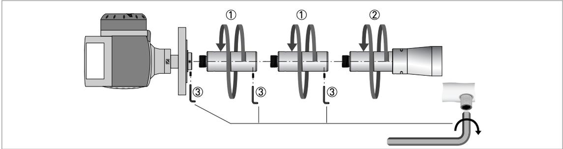
Рисунок 2-14: Рупорная антенна - как присоединить антенные удлинители
