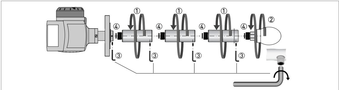
Рисунок 2-15: Каплевидная антенна - как присоединить антенные удлинители
