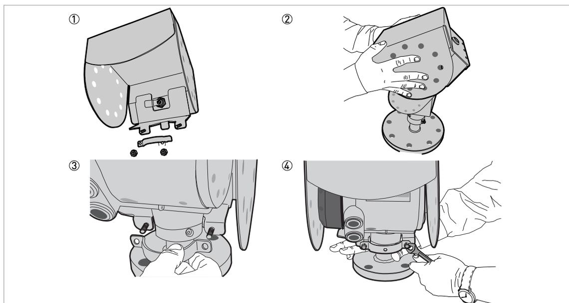
Рисунок 2-17: Установка защитного козырька
