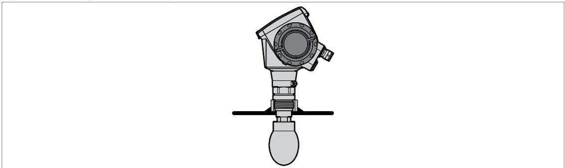
Рисунок 2-13: Резьбовое технологическое присоединение
