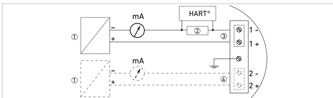
Рисунок 3-2: Электрическое подключение для невзрывозащищённых приборов
