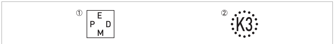
Рисунок 2-5: Символы материала уплотнительной прокладки (на боковой стороне технологического присоединения)
