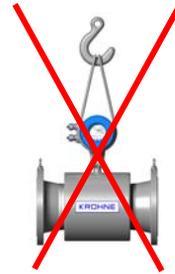
Stellen Sie den Durchflussmesser niemals auf dem Gehäuse des Messumformers ab.
